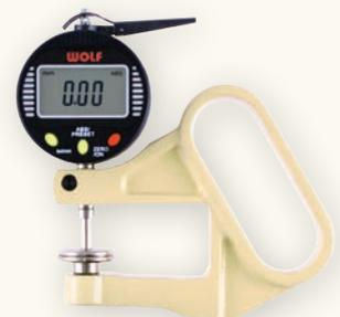
Bei leicht zusammendrückbaren Materialien wie Leder, Vlies und Textil ist für eine Vergleichbarkeit der Messwerte der Prüfdruck entscheidend. Entsprechend den geltenden Normen bringen diese Spezialausführungen der Reihen DMD und DMH die vorgeschriebenen Prüfdrücke auf eine festgelegte, kreisförmige Tasterfläche auf. Um den Prüfdruck gewährleisten zu können, werden diese Geräte ausschließlich mit Standfuß angeboten.
